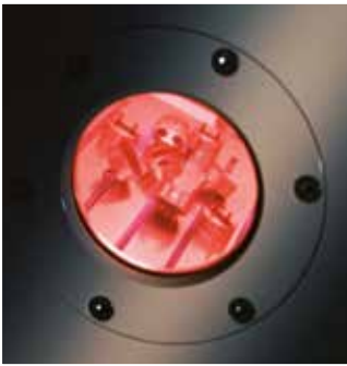
Blick in die Reaktionskammer einer Niederdruck-Plasmaanlage während eines Reinigungsprozesses.
