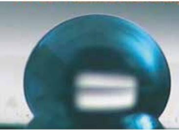
Hydrophobe Polymeroberfläche vor einer Behandlung im Niederdruck-Plasma.
