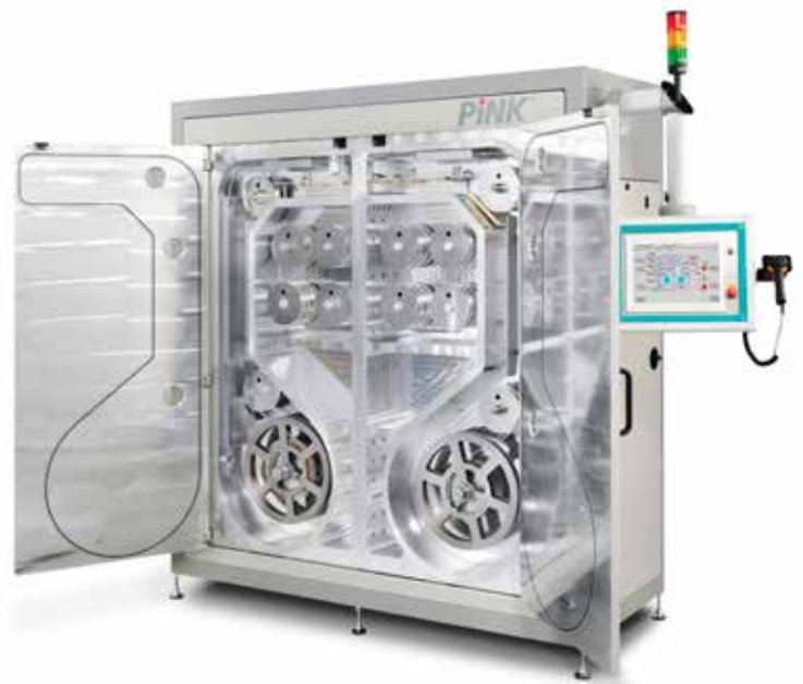
Mit der Rolle-Rolle-Anlage V200-8G-K-RR wird die Oberfläche von Leadframes gereinigt.
