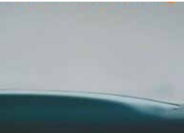
Nach der Plasmabehandlung verfügt die gleiche Oberfläche über hydrophile Eigenschaften.
